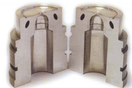
Slika 4: Šoba za brizganje, izdelana s hibridno tehnologijo. Spodnji del (do črte na notranji steni šobe pod hladilnim kanalom) je obdelan z odrezavanjem odvečnega materiala. Zgornji del, kjer je speljan hladilni kanal, je nataljen s postopkom SLT.
