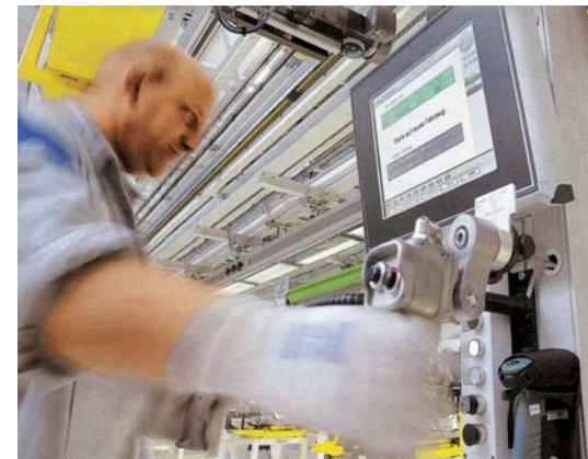
Izboljšanje procesa z brezžičnim omrežjem iWLAN: delavec v Volkswagnum v Emdnu na zaslonu spremlja stopnje dela, stroji samodejno zavzemajo ustrezen položaj, sistem pa zagotavlja, da se deli pravilno povezujejo.
