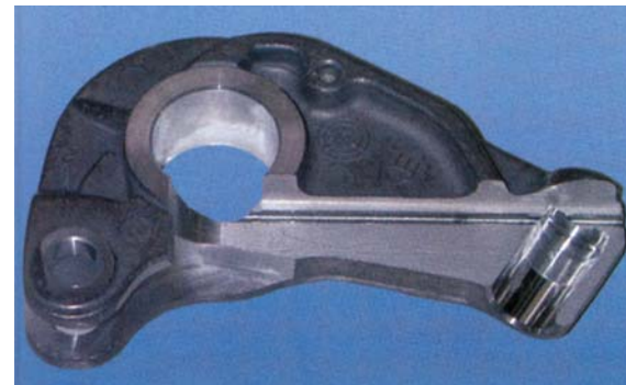
V obdelovance iz legiranega jekla visoke trdnosti, npr. elementi za dizelske motorje, je treba izdelati izvrtine majhnih premerov in globine do 15xD.
