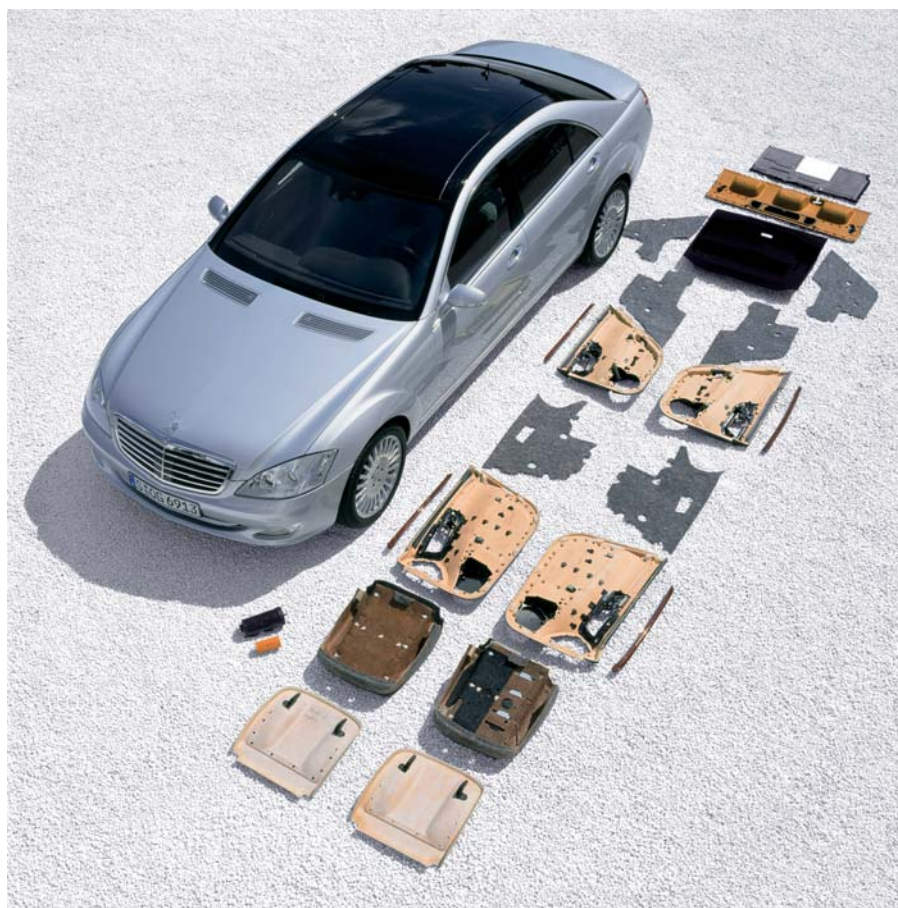
Slika 7: Deli, ojačani z naravnimi vlakni, v mercedesu razreda S (foto: Daimler AG)
