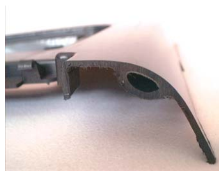
Slika 4: Kanal za plin, izveden na radiu izdelka (povečanje togosti izdelka in s tem zmanjšanje zvižanja)
