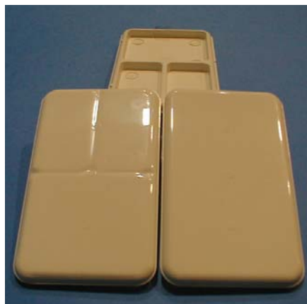
Slika 8: Posedenost izdelka levo in rešitev desno
