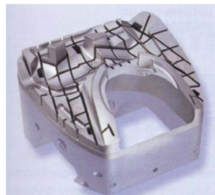
Slika 7: Vložek orodja za brizganje plastike z integriranimi prilagojenimi hladilnimi kanali
