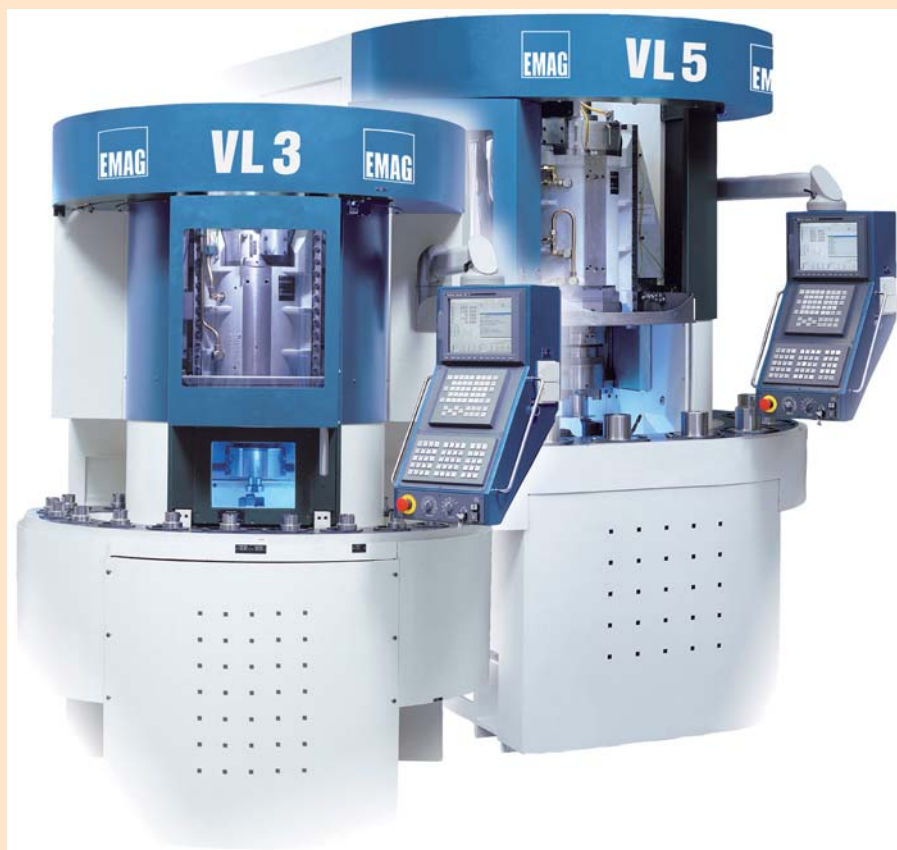
EMAG VL 3 in VL 5: Standardna vertikalna stružna centra EMAG VL 3 in VL 5 s premerom čeljusti 160/250 mm pokrivata najrazličnejše aplikacije pri podizvajalcih.
