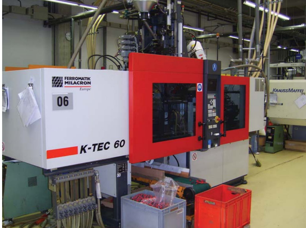
Slika 4: 2K-brizgalni stroj za izdelavo držala, pokrova in ustnika
