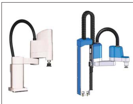
Slika 4: Primerjava klasičnega robota SCARA z razvito strukturo
