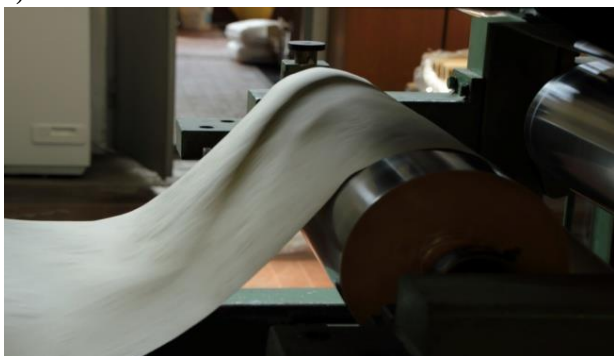
Slika 3: Pilotni papirni stroj (ICP) a) in papir iz japonskega dresnika b)
