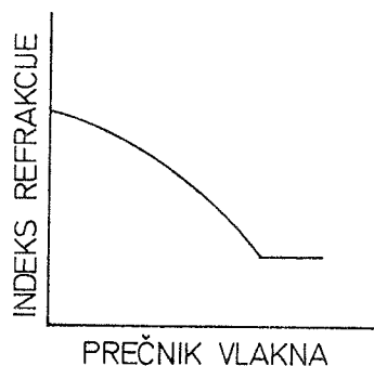
Slika 10.: Kompenzacija "centralnog ulegnuća" dodatkom GeO_2 u zaštitni sloj
