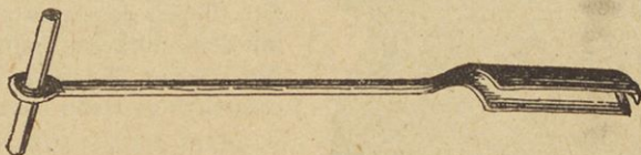
Pod. 77. Sveder za vrtanje lukenj v zemljo.
