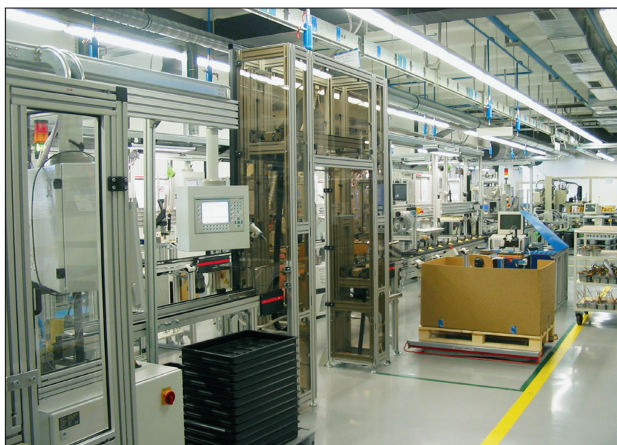
Sledenje podatkov o vseh vgrajenih sestavnih delih po serijskih številkah oz. šaržah pri proizvodnji elektromotorja za pomoč vrtenja volanskega droga pri Oplu Corsi
