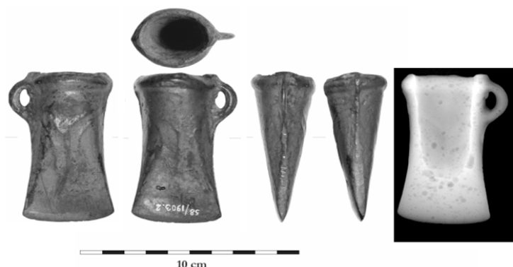
Slika 3. Geometrija artefakta in rezultat nevtronske radiografije.
