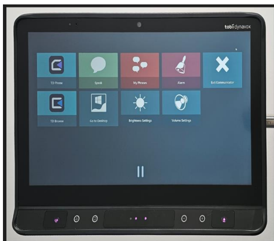
Slika 11: Naprava za nadomestno in dopolnilno komunikacijo z možnostjo upravljanja z očmi (NDK) (Vir: Strokovna knjižnica URI Soča, 2025)
