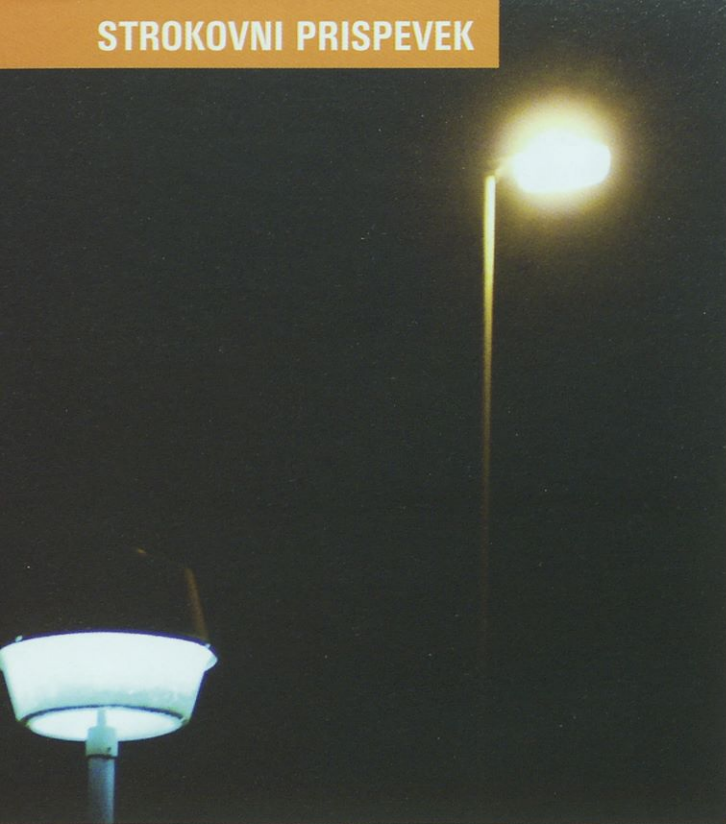
Slika 5. Nezasenčene svetilke se bleščijo in po nepotrebnem sijejo v nebo.
