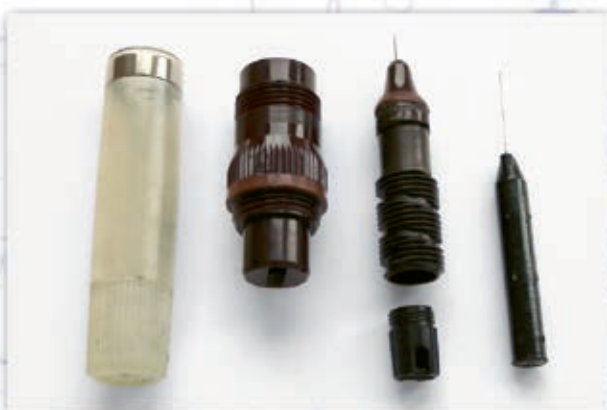
Sestavni deli Rotring rapidografa iz leta 1985. Ključen sestavni del rapidografa je cevka, v kateri je zelo tanka kovinska nitka. Ta je na notranji strani rapidografa povezana z njegovim mehanizmom dovajanja črnila, na zunanji strani pa je le malo daljša od cevke in skrbi za stik črnila s pisalno podlago po principu kapilarne privlačnosti. Debelina cevke določa debelino črte, ki jo naredi rapidograf pravokotno na podlago.
