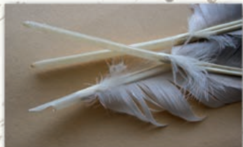
Tri gosja peresa v različnih fazah izdelave: zgornje pero je nespremenjeno; pero na sredini je očiščeno in zloščeno; spodnje pero pa ima dokončno izoblikovano konico za pisanje.
