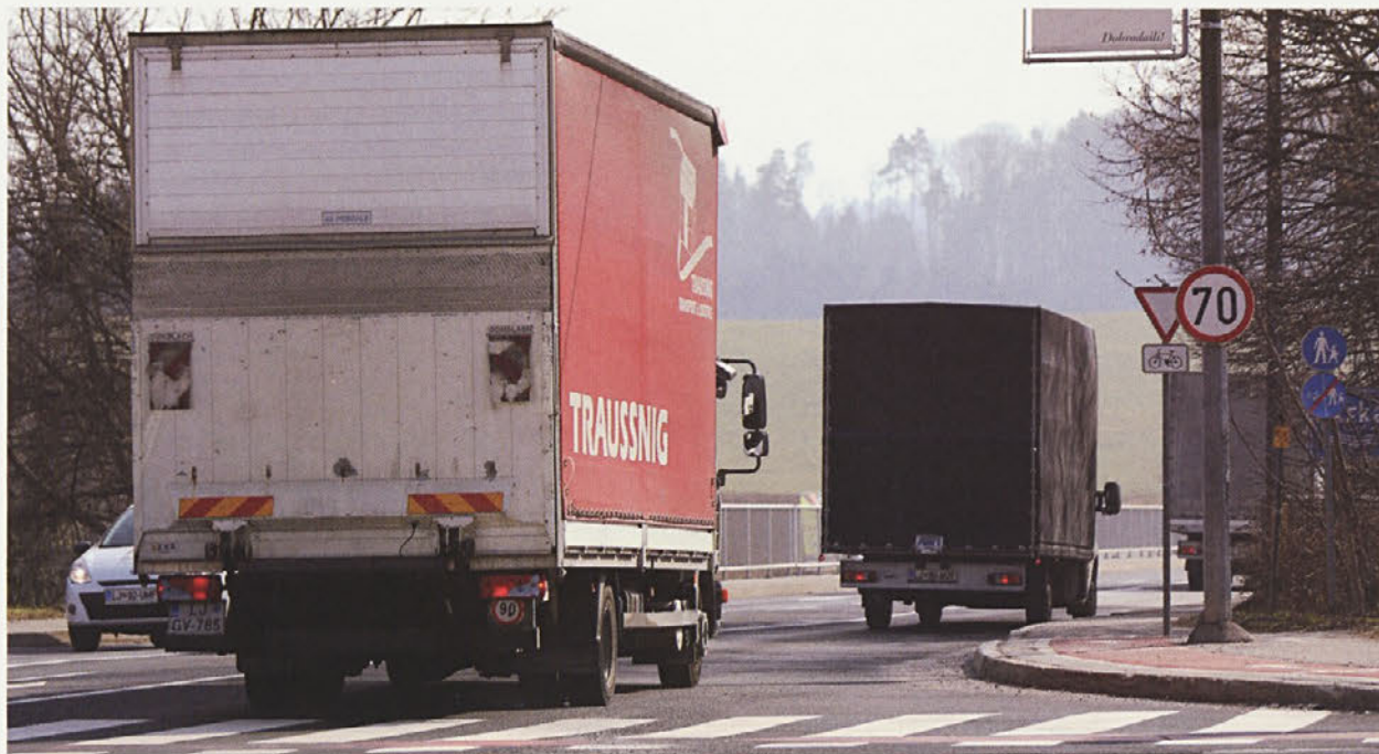
Neustrezen prometni znak na vstopu na Ločenski most iz križišča v Ločni, ki dovoljuje vožnjo po mostu do 70 km/h, slabo viden pa je tudi moder prometni znak, ki prepoveduje vožnjo kolesarjem po površinah, ki so namenjene pešcu (foto: Boštjan Pucelj).
