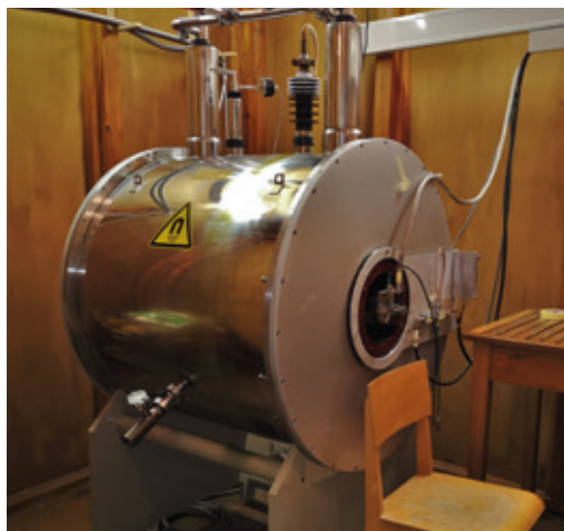
Slika 3: Primer superprevodnega magneta za slikanje z magnetno resonanco v raziskovalne namene, ki se nahaja na Institutu Jožef Stefan v laboratoriju za MR slikanje.
