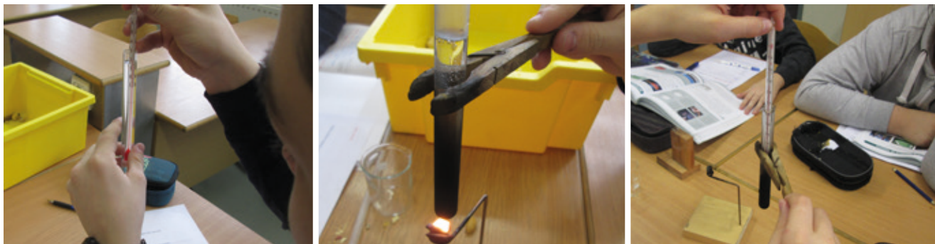
Slika 3: Gorenje arašida in določanje prejete toplote z merjenjem temperature vode.
