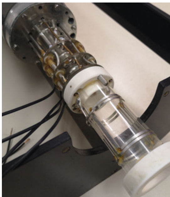
Slika 4: Primer oddajno-sprejemne RF tuljave, instalirane v RF sondo, ki se uporablja na Institutu Jožef Stefan v laboratoriju za MR slikanje.
