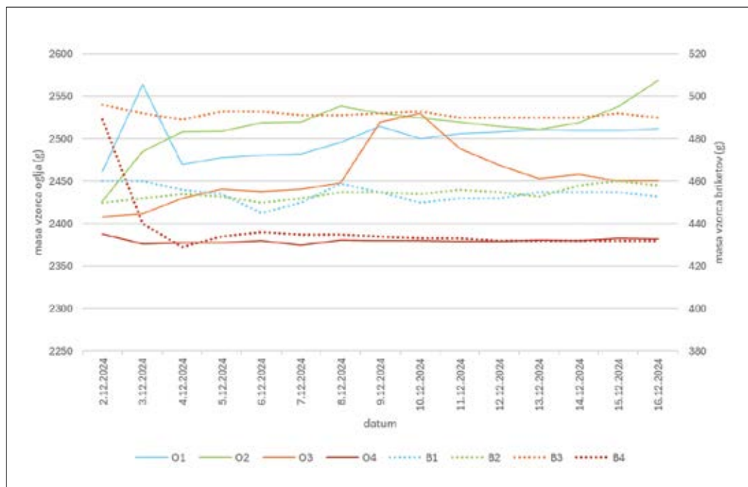
Slika 3: Razlika v masi vzorcev lesnega oglja in briketov lesnega oglja od 2. 12 do 16. 12. 2024
