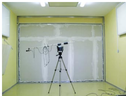
Slika 4 • Postavitev testne stene za preizkus zvočne izolirnosti elementov Qbiss Air na notranji strani (leva slika) in zunanji strani (desna slika)
