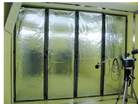
Slika 4 • Postavitev testne stene za preizkus zvočne izolirnosti elementov Qbiss Air na notranji strani (leva slika) in zunanji strani (desna slika)
