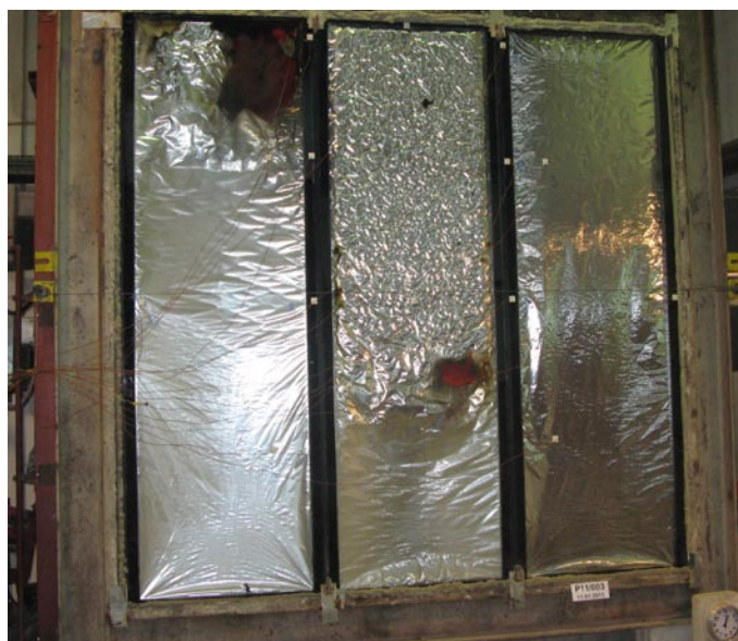
Slika 7 • Začetek požarnega testa (levo) in konec testa (desno). Ogenj je steno Qbiss Air prebil v 78. minuti
