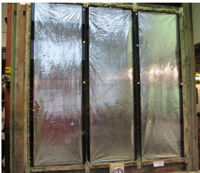
Slika 7 • Začetek požarnega testa (levo) in konec testa (desno). Ogenj je steno Qbiss Air prebil v 78. minuti
