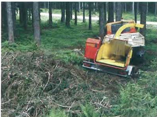
Slika 1: Mletje sečnih ostankov po redni sečnji s strojem Lignatec Chromcom M 110 (Pokljuka, 1998)
