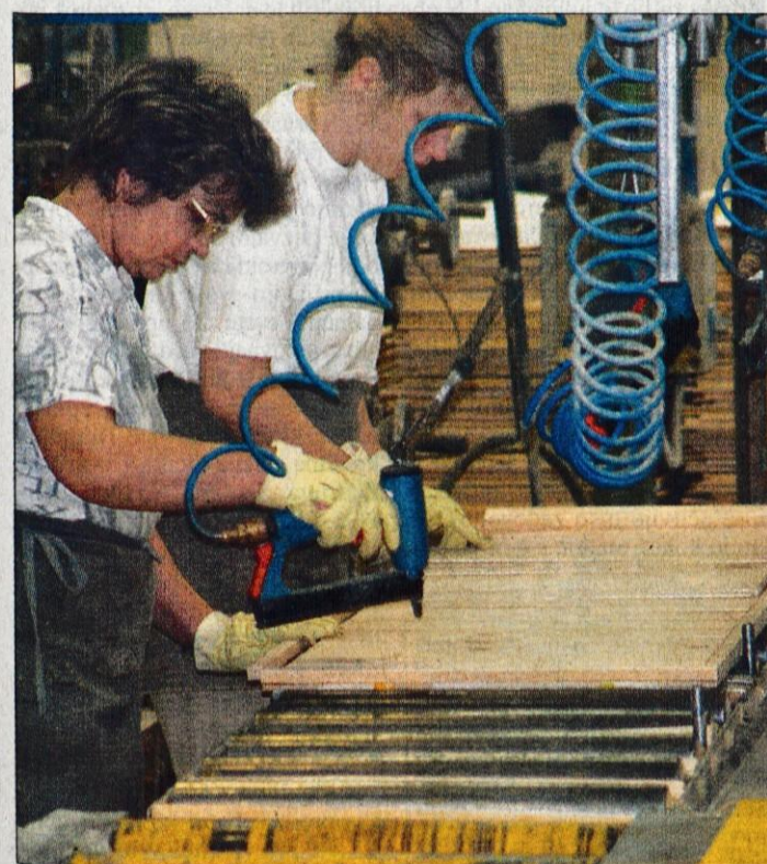
Proizvodnja opaznih plošč v obratu LIP Bled v Bohinjski Bistrici.
