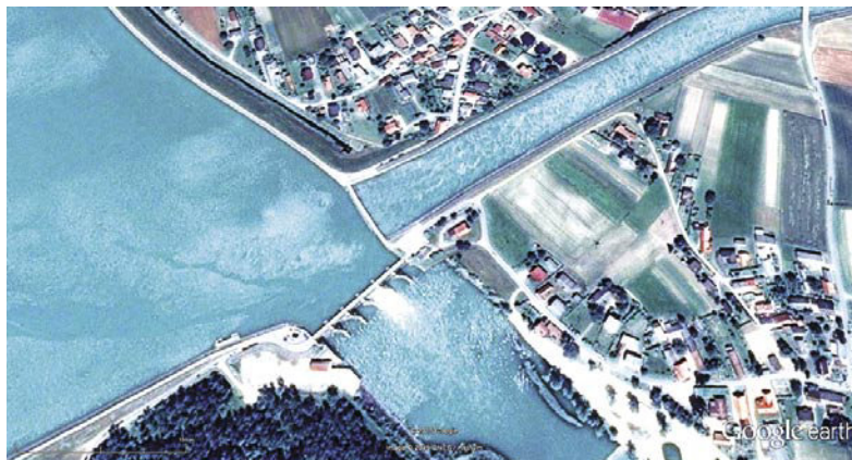
Slika 3 • Jez HE Formin s spodnjo Dravo in energetskim kanalom do HE Formin. Mala HE, po predlogu projektanta, pa so končno (levo do jezu) po mnogih letih le zgradili
