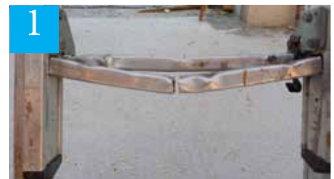
Slika 1: Poškodovan klin lestve
