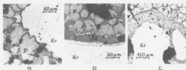
Slika 2a, b, c: Kalcijevo silikatna talina je topila površino kromitnega zrna in ga korodirala. Kromit se je ponovno izločal v t.i. reakcijskem obroču. Ods.v., Kr - kromit, P - periklaz
