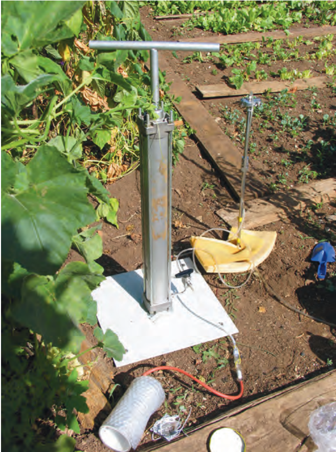
Odvzem vzorcev talnega zraka z alfa scintilacijskimi celicami za meritve trenutnih koncentracij radona.
