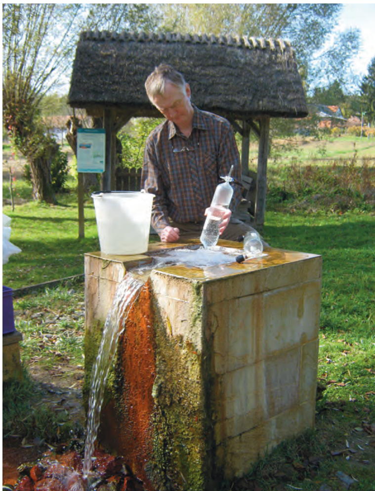
Odvzem vzorcev plina iz mineralne vode na vrtini Nu-9 v bližini mojst v Ledavi.
