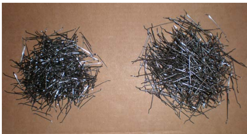
Slika 4.1: Uporabljeni jeklena vlakna (levo IRI 50/16 (VJ1) in desno IRI 50/30 (VJ2))
