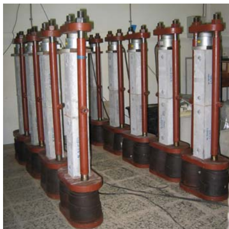
Slika 4.95: Prizme iz vlaknastega betona, vpete v jeklene jarme za preiskavo lezenja vlaknastega betona.
