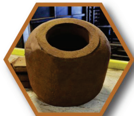
izolacijski oblikovanci za zaščito curka taline z argonom med procesom vlivanja v kokile
