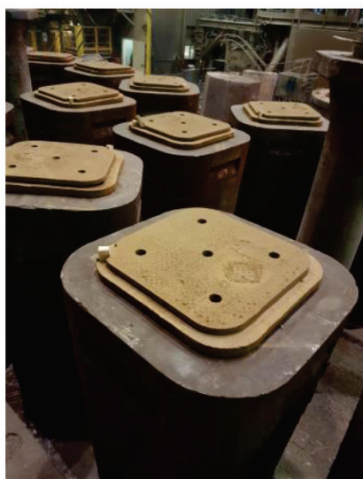
kokile za litje ingotov pokrite z izolacijskimi pokrovi na vlivališču
