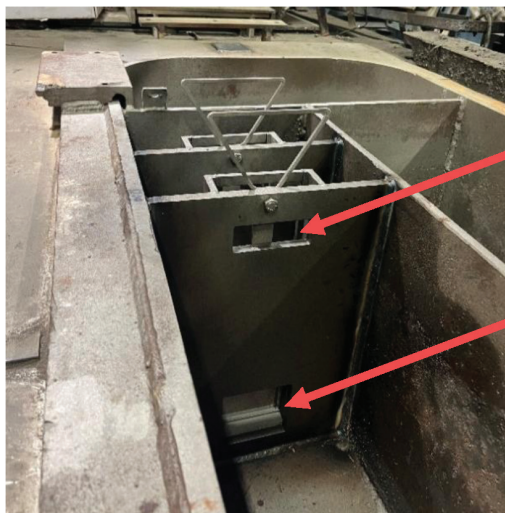
Implementacija filtracijskega sistema z enostavnim izvlekom filtra ter dvema filtracijskima zaporama
