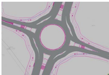
Slika 7 • Matematični model in 3D-simulacija krožnega križišča s pritisnjenimi pasovi za desno zavijanje, izdelana s PTV VISSIM 5.20
