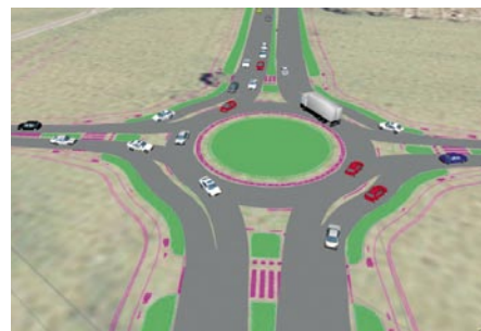
Slika 7 • Matematični model in 3D-simulacija krožnega križišča s pritisnjenimi pasovi za desno zavijanje, izdelana s PTV VISSIM 5.20
