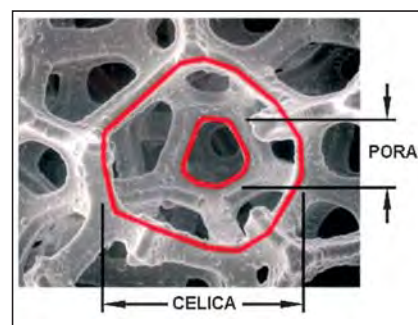
Slika 1. Fotografija aluminijastega odprtoceličnega poroznega materiala z 88-odstotno poroznostjo proizvajalca ERG materials
