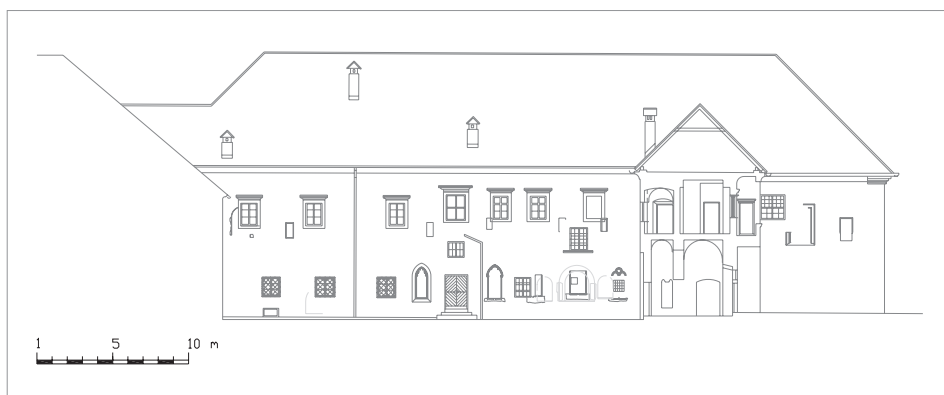
Naris južne stene samostana z romanskimi in gotškimi stavbnimi elementi (Risba: B. Vnuk 2014).
