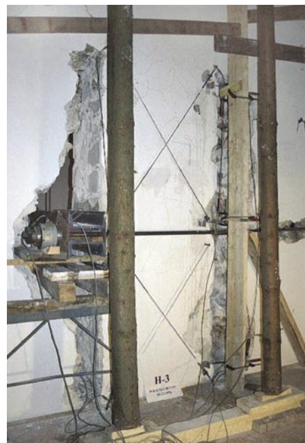
Slika 10 • Preiskava potresne odpornosti kamnitega zidu na terenu
