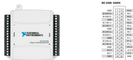
Slika 2: Kartica NI USB 6009 in razporeditev vhodno-izhodnih priključkov
