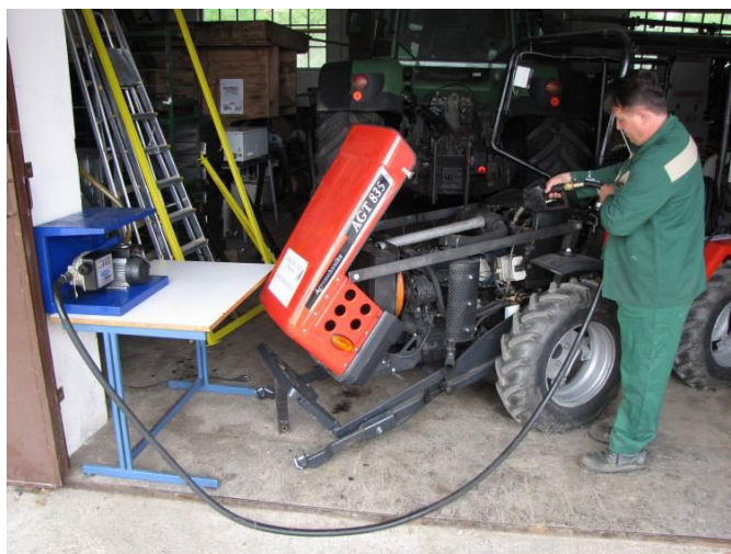
Slika 3: Primer merjenja porabe goriva z volumetrično metodo
