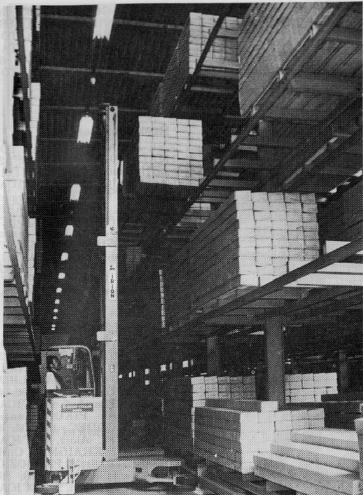
V TO Rečica so pričeli uporabljati regalno skladišče s pomočjo štiripotnega viličarja
