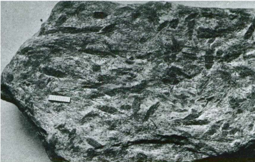
Sl. 2. Kontaktno metamorfoziran filit s porfiroblasti kordierita. Dolina Bistre pri Črni na Koroškem Abb. 2. Kontaktmetamorphosierter Phyllit mit Porphyroblasten von Cordierit. Bistratal bei Črna na Koroškem
