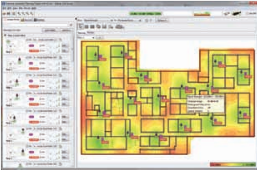
△ S programom Ekahau Heatmapper si lahko izdelamo natančen načrt pokritosti z brezžičnim signalom in tudi najdemo najboljši položaj za našo brezžično opremo.
