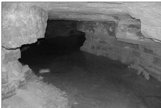
Slika 1: Plastem apnenca so v Spodnjem Oseku sledili pod površje. Po prenehanju pridobivanja kamnine se je v opuš enih rovih izoblikovalo ob asno podzemeljsko jezerce.
