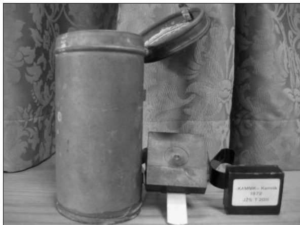
Slika 5: Razporna nika s škatlo, v kateri so se hranili. Na železnici se ve ne uporabljajo. Razporna nika so se v izjemnih primerih, ko je bilo treba ustaviti vlak, postavili na tračnico. Zaradi vsebine z razstrelivom je prišlo do poka, kar je za strojevodjo pomenilo, da se mora ustaviti.
