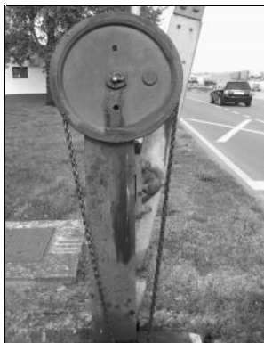
Slika 11: Mehanizem za zapornice na postaji Središ e. Foto: Franc Krnjak, Središ e 2. 10. 2008.
