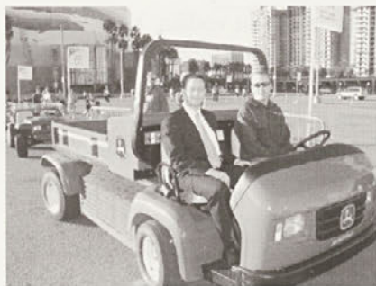
John Deere poltovorno vozilo z gorivnimi celicami in Domelovim EC puhom
