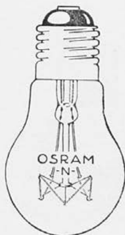
Osramova žarnica s spiralno žico v brezračnem prostoru.
