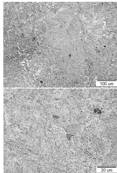
**Figure 1:** Optical micrographs of the steel microalloyed with niobium (steel A) at different magnifications**Slika 1:** Mikrostruktura jekla, mikrolegiranege z niobijem (jeklo A), pri različnih povečavah (svetlobni mikroskop)
