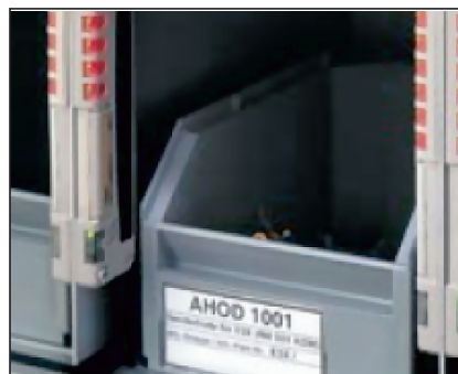
Slika 4. Zanesljiva montaža z osvetljeno kontrolo t. i. picking senzorja, ki preprečuje napake pri montaži zaradi zmedenosti, menjave delovnega mesta ali neustreznega učenja delavca
