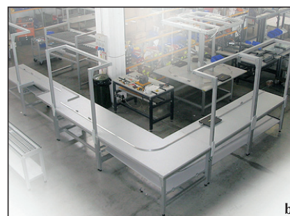
Slika 1. Vračanje palet pri linijski montaži pod delovnim nivojem: a – montaža v ravni liniji, b – linija, prilagojena prostoru
