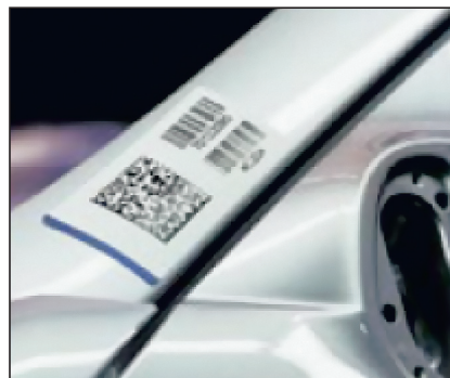
Slika 3. V tovarni Daimler Chrysler se matrična koda uporablja za končno in posamično sestavo avtomobila. Uporaba te kode je dosti enostavnejša in cenejša od kode RFID, distanca branja pa lahko seže do 2 m. Ustreza normativom TS16949 za sledljivost v avtomobilski industriji.
