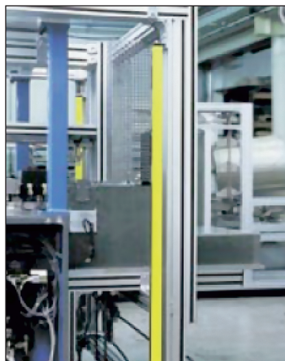
Slika 5. Tovarna Delphi (Francija) proizvaja več kot 2 milijona klimatskih naprav letno. Zaradi preproste vgradnje in kompaktnih dimenzij so se odločili za uporabo varnostnih zaves F3SN.
