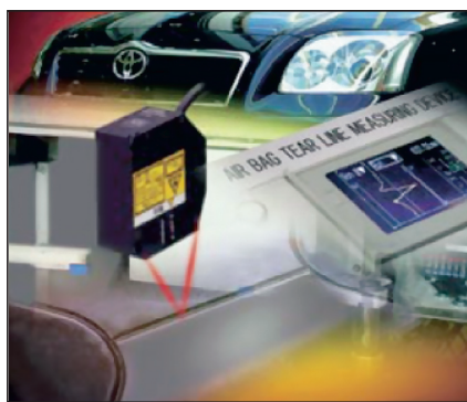
Slika 2. Tovarna Toyota (UK) uporablja laserski profilni senzor Z500 za natančno meritev globine razporka zračne varnostne blazine na modelu Avensis. Proces kontrole je zelo kritičen, saj mora zagotavljati popolnost in 100-odstotno delovanje v primeru trka. Vsi rezultati se shranjujejo. Sistem Z500 omogoča meritev z natančnostjo 0,25 µm.
