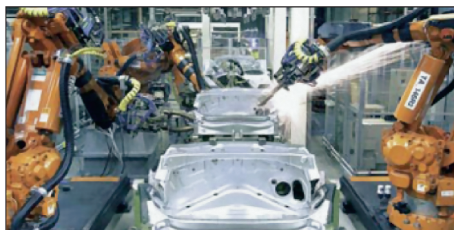
Slika 6. V avtomobilski tovarni Valmet (Finska) je bilo do danes izdelanih preko milijon avtomobilov in od leta 1997 več kot 100.000 tipa Porsche Boxster. Šasija, barvanje in končna montaža so izvedeni s sistemom Omron PLC, povezanim preko komunikacij Ethernet, Controller Link ali Device Net. Poleg tega Valmet uporablja Omronovo senzoriko, frekvenčne pretvornike, RFID in sisteme za vizualno kontrolo.
