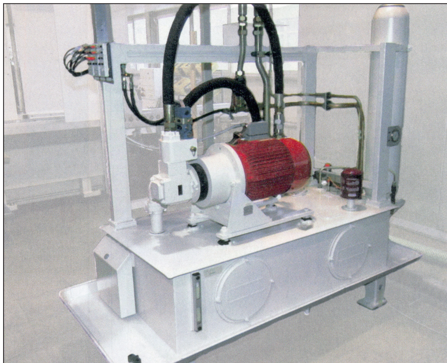
Hidravlični agregat za akumulatorski pogon, ki omogoča obratovanje z znižanjem hrupnosti ob sočasnem varčevanju z energijo
