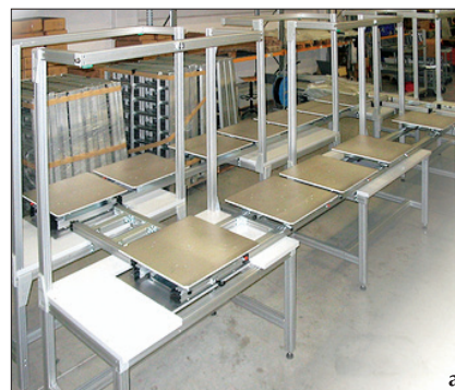
Slika 1. Vračanje palet pri linijski montaži pod delovnim nivojem: a – montaža v ravni liniji, b – linija, prilagojena prostoru
