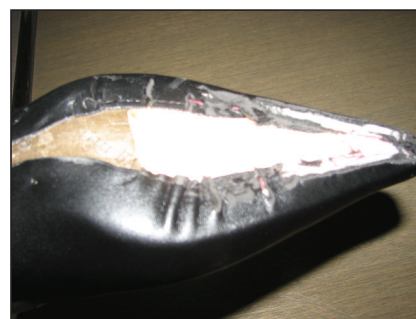
Slika 12. Nagubano usnje na podplatu, ki ga je potrebno odbrusiti. Konica čevlja je že obrušena.
