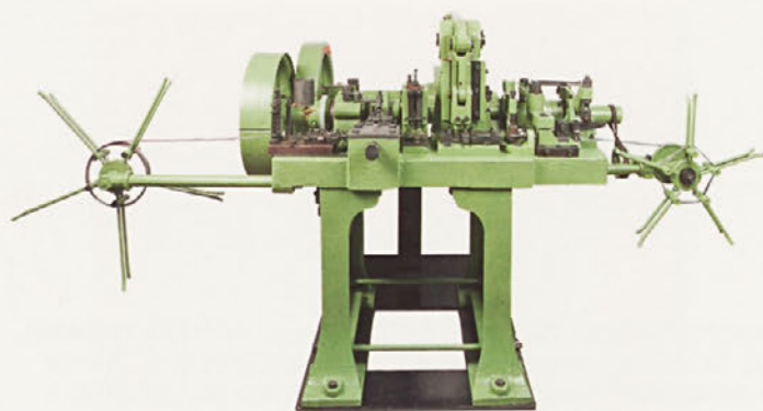
stroj za izdelavo risalnih žebličkov neznanega proizvajalca. Pripeljan v Železnike okoli leta 1925 in obnovljen leta 2011.
