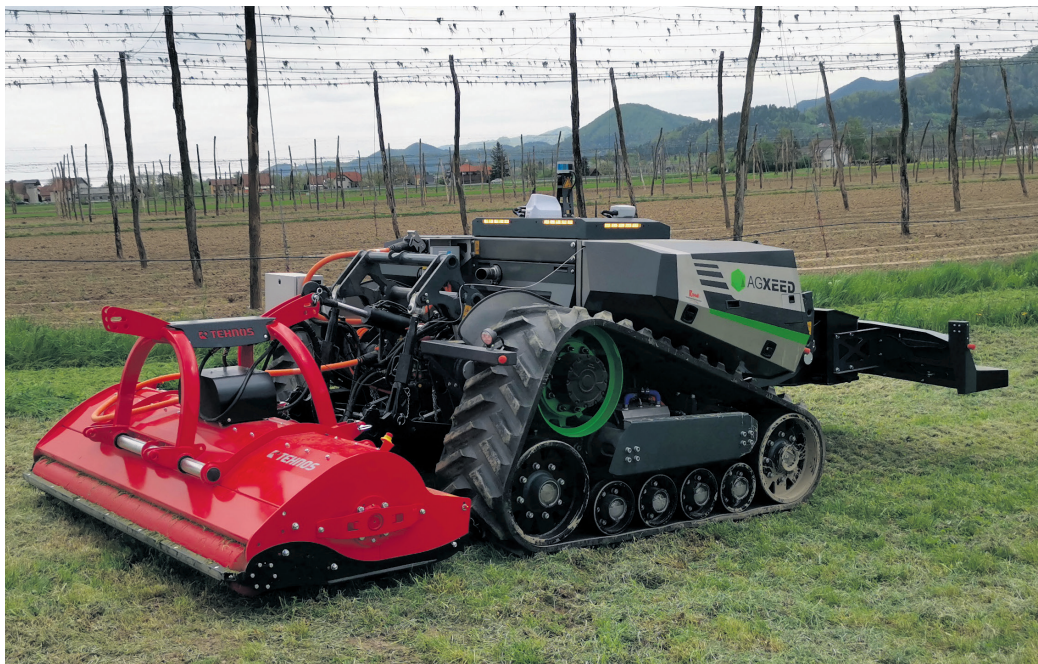
Novost med kmetijskimi stroji žalskega Tehnosa je električni mulčer, ki poleg ekološke neoporečnosti omogoča tudi visoko stopnjo avtomatizacije in ga je mogoče uporabljati na popolnoma samovoznih traktorjih. (Foto: arhiv podjetja)
