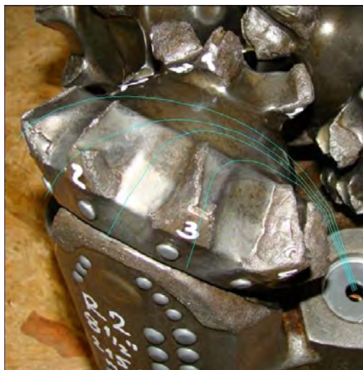
Slika 8. Poenostavljena slika strujenja izplake preko kotal dleta
