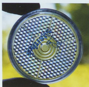
Slika 6: Notranja površina odsevnika je iz mnogih vogalov kock.
