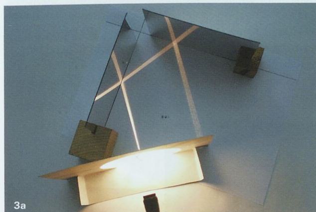
Slika 3: Odboj svetlobe od dveh pravokotnih ravnih zrcal. Fotografiji a) in b) kažeta poskusa, ko s svetilko svetimo proti zrcaloma iz različnih smeri. c) Shematičen prikaz dvakratnega odboja na dveh pravokotnih zrcalih.
