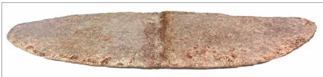
Slika 2. Mycosurf – projekt deska za surfanje, izdelana iz glivnih biokompozitov, je zasedel 3. mesto med Rektorjevimi nagradami za najboljše inovacije Univerze v Ljubljani v kategoriji študentov in alumnov UL (Foto: Nej Bizjak).
