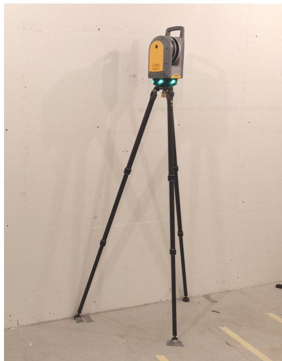
Slika 1: Fotografija laserskega skenerja Trimble X7 v uporabi.
