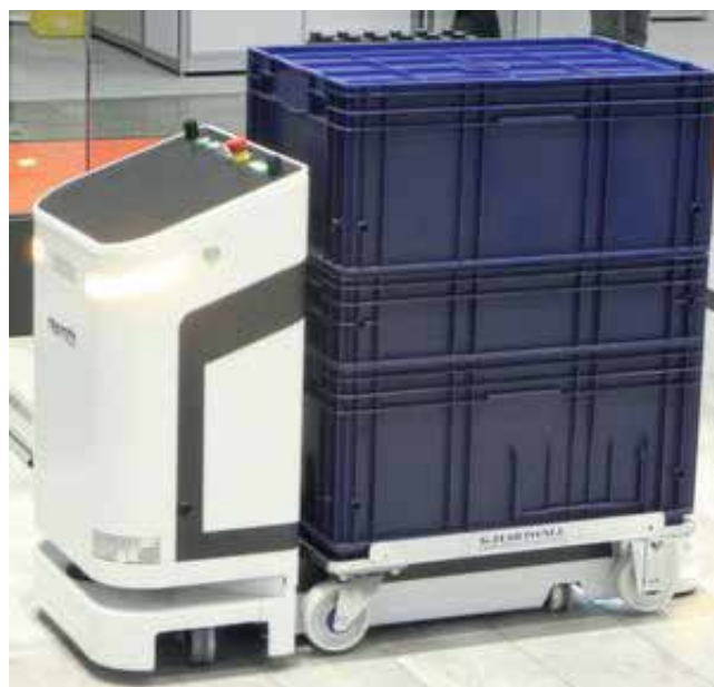
Slika 2 : Active Shuttle z vozičkom Dolly in zaboji KLT
