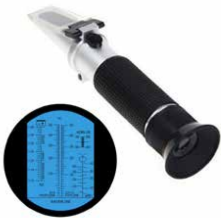
Slika 2 : Refraktometer – pripomoček za merjenje odstotka glikola
