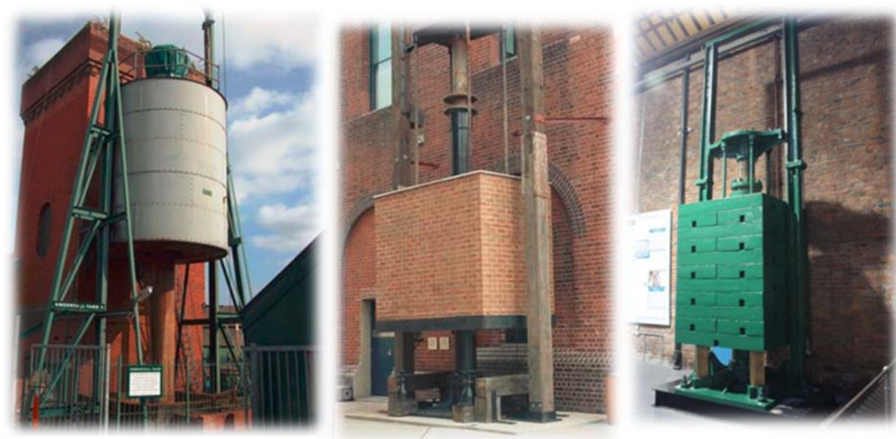
Slika 5 : Hidravlični akumulatorji z utežjo: pristanišče v Bristolu (levo), Walsh Bay v Sydneyju (sredina) in kot izvedba za vgradnjo v notranji prostor (desno) [12]
