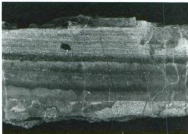
Sl. 13. Del zapolnjene votline, nastale pri zakrasevanju. Ritmično menjavanje peletov v mikritni osnovi in sparita. Reto-lias, Grmače
