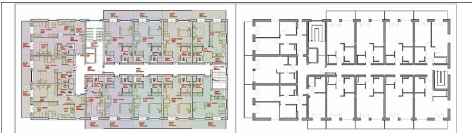
10 Različne kombinacije vidnosti posamezne etaže (ali več etaž) lahko sedaj lažje nadziramo z novimi orodji in tako prikazujemo le želene informacije tako med risanjem, kot kasneje pri tiskanju
