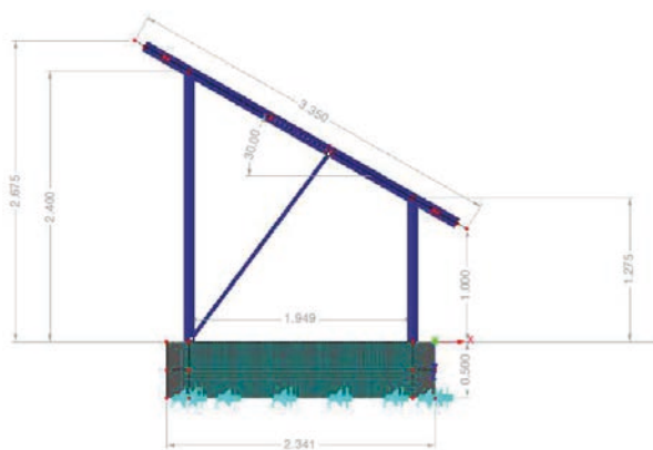
Slika 4: Podrobnejša predstavitev načrta konstrukcije za montažo panelov fotovoltaične elektrarne D3 (HESS, 2023)
