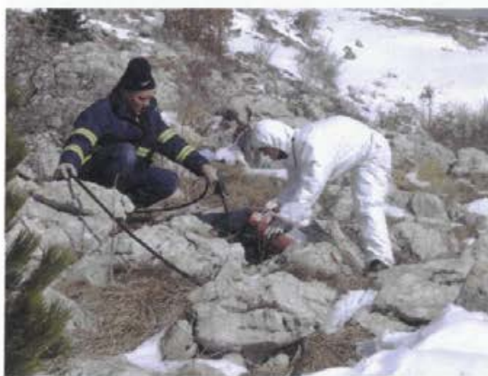
Injiciranje fluorescentnega sledila eozin v kraško razpoko (foto: N. Ravbar)
