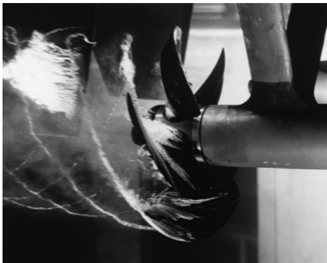
Slika 2. Vijačnici mehurčkov, ki so nastali pri kavitaciji v vodi na konicah vrtečega se vijaka [6].
