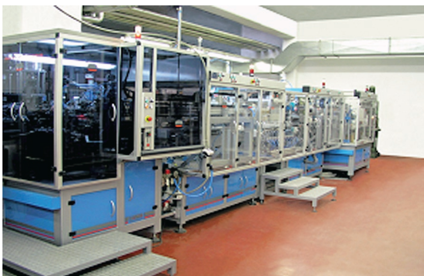
Slika 1. Montažni sistem za sestavljanje grelca
