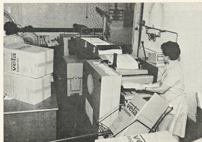
15 do 20 rolic na minuto, odvisno od regulacije glede na vrsto tapet, zgaufriira in zrola najnovejši stroj v tozdu Veta. Roke Ane Nemec morajo biti kar hitre, da to količino rolic sproti odzamejo in nalagajo v kartonske škatle. Pa tudi oči morajo biti ves čas na preži
