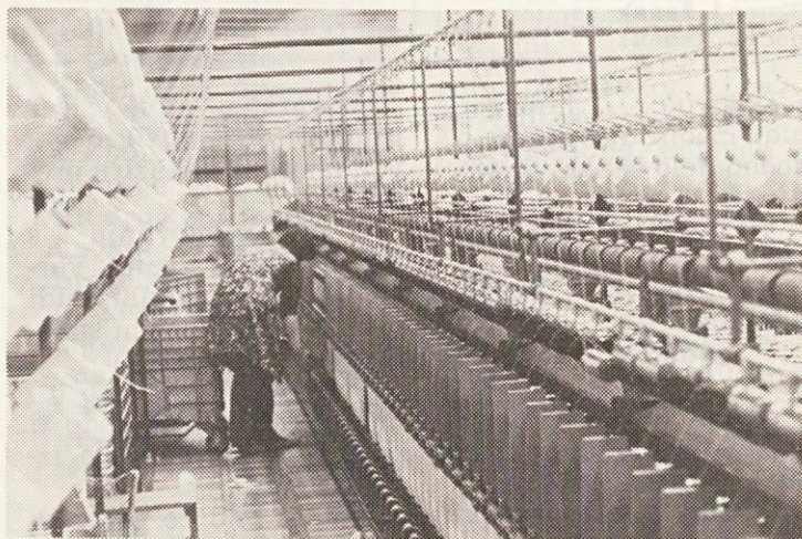
Predelan klasični sukalnik v sukalnici za efektne sukance.
